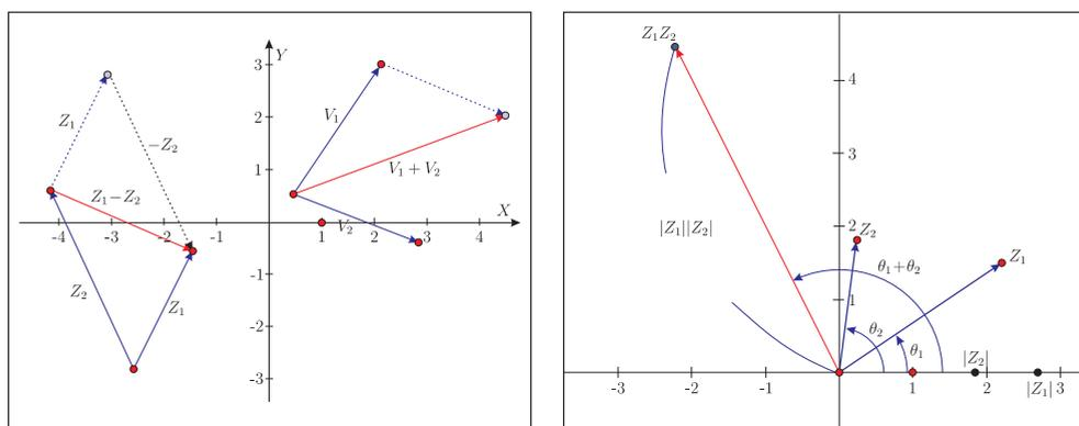
圖3: 左圖: 複數向量加減的平行四邊形法則, 右圖: 複數的乘法
