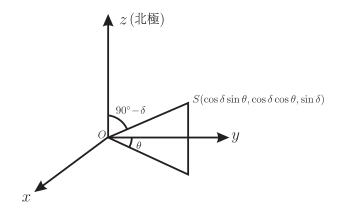
正午時太陽在正南,對應  $\theta=0^\circ$ ,此時太陽的方向向量是  $(0,\cos\delta,\sin\delta)$ 。由於地球由西向東 繞北極自轉,因此在正午以後,太陽的方向向量  $(0,\cos\delta,\sin\delta)$  向著 x 軸 (指向西方),繞 z 軸 轉了  $\theta$  角,新的方向是  $(\cos\delta\sin\theta,\cos\delta\cos\theta,\sin\delta)$ 。如果要了解這個方向在北京的仰角  $\gamma$ , 或者  $\cos(90^\circ-\gamma)$ ,就要將此方向與在北京立竿的方向  $(0,\cos40^\circ,\sin40^\circ)$  作內積而得到  $\gamma$ 、  $\theta$  和  $\delta$  的關係式:
