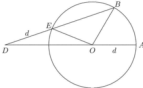
長度  $d$  為二刻尺的兩個刻度中間的距離。用圓規畫一個以  $d$  為半徑及  $O$  為圓心的圓。設角  $\angle BOA$  為將被分成三份的角。利用二刻尺去畫一直線  $BE$ , 使它與直線  $AO$  相交於  $D$  點及線段  $\overline{ED}$  的長度等於  $d$ 。由於三角形  $\triangle DEO$  是等腰三角形, 可得  $\angle EDO = \angle EOD$ ; 而  $\angle OEB = \angle EDO + \angle EOD = 2\angle EOD$  (三角形的外角)。由於三角形  $\triangle EOB$  是等腰三角形, 可得  $\angle OBE = \angle OEB = 2\angle EOD$ 。最後得到  $\angle BOA = \angle EOD + \angle OBE = 3\angle EOD$  (三角形的外角), 所以  $\angle EOD$  是  $\angle BOA$  的三分之一。
