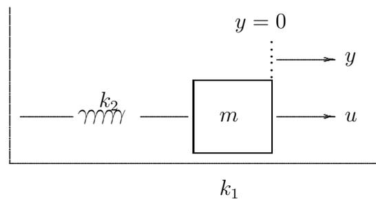
$k_1$ 代表摩擦係數, $k_2$ 代表彈性係數,而 $y$ 表示位移, $u$ 表示外力,根據虎克定律和牛頓第二運動定律,我們得到以下的物理式子:
