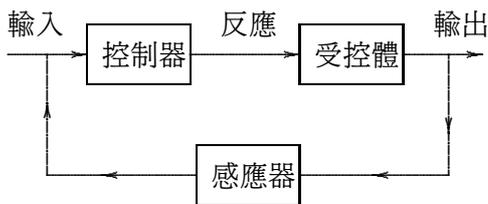
以下我們將以閉迴路系統爲基礎,討論一些控制理論上的課題。下圖是一個基本控制系統的圖形,其中C代表的是控制器,P和F代表基本系統,r、d、n表示外界干擾信號。
