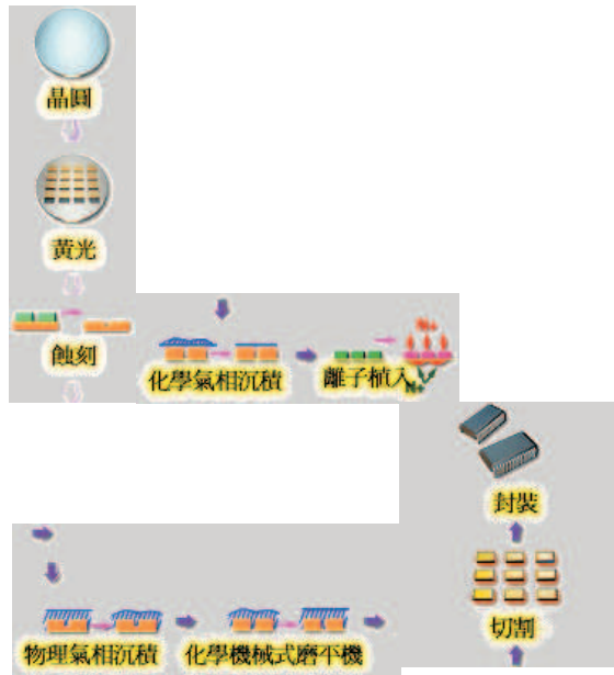
圖一. 半導體簡要製造過程
